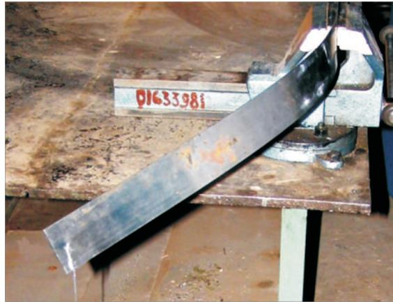
Рис. 6. Вид на нагруженный экспериментальный образец
