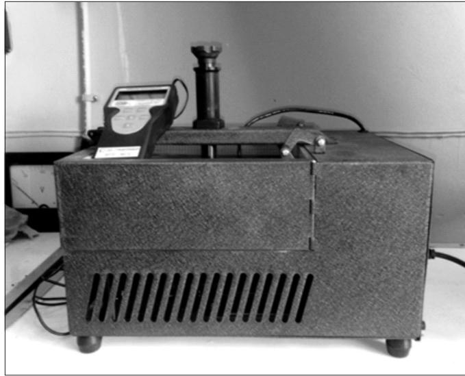
*Рис. 3. Измеритель теплопроводности ИТП-МГ 4 «250»*
