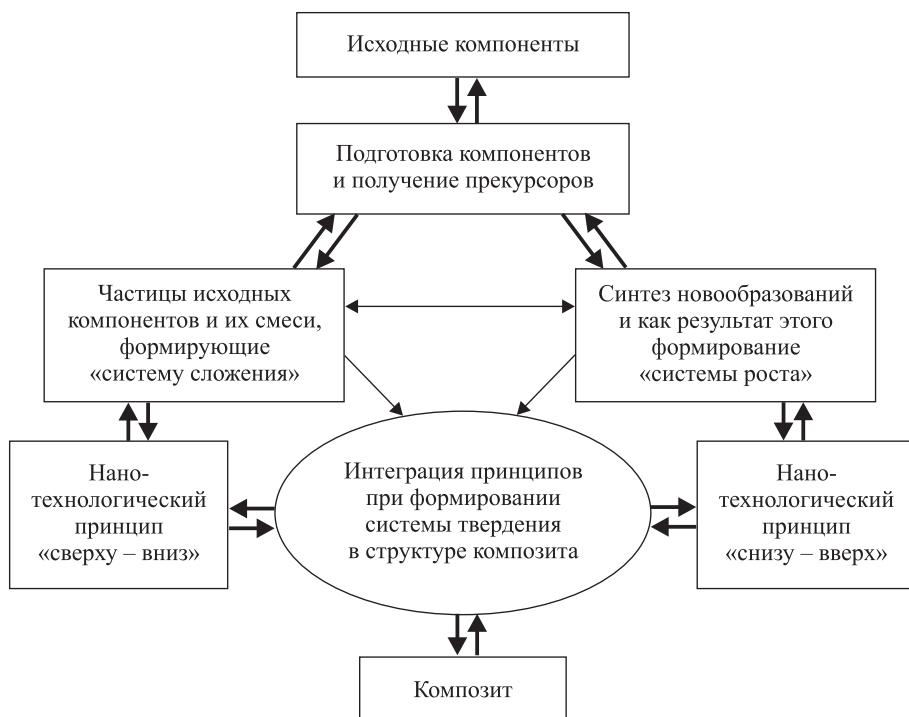
*Рис. 1. Общая схема формирования структуры строительных композитов с позиций нанотехнологического подхода*
