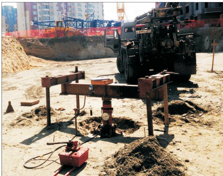
Фото полевого определения несущей способности сваи
